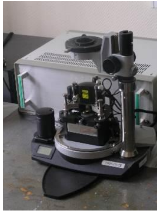
Рисунок 2.4 – Внешний вид измерительной головки прибора на плоском основании
