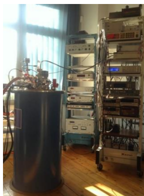
Рисунок 2.6 – Общий вид установки для измерения магнитострикции со сверхпроводящим соленоидом
