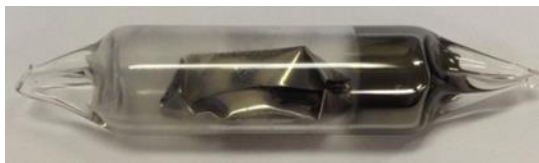
Рисунок 2.3 – Внешний вид образцов \text{RCO}_2 после отжига в кварцевых ампулах
